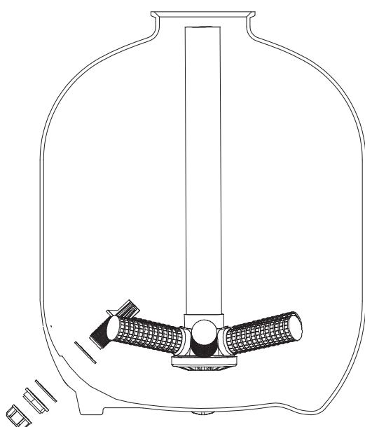
Plaats het voltooide verdeelstuk op de basis in het midden van de tank en vul tot halverwege met water om het te stabiliseren. Zorg ervoor dat het stervormig gaas goed is gecentraliseerd op de bodem van het filter en dat de aftapschroef dicht is.
