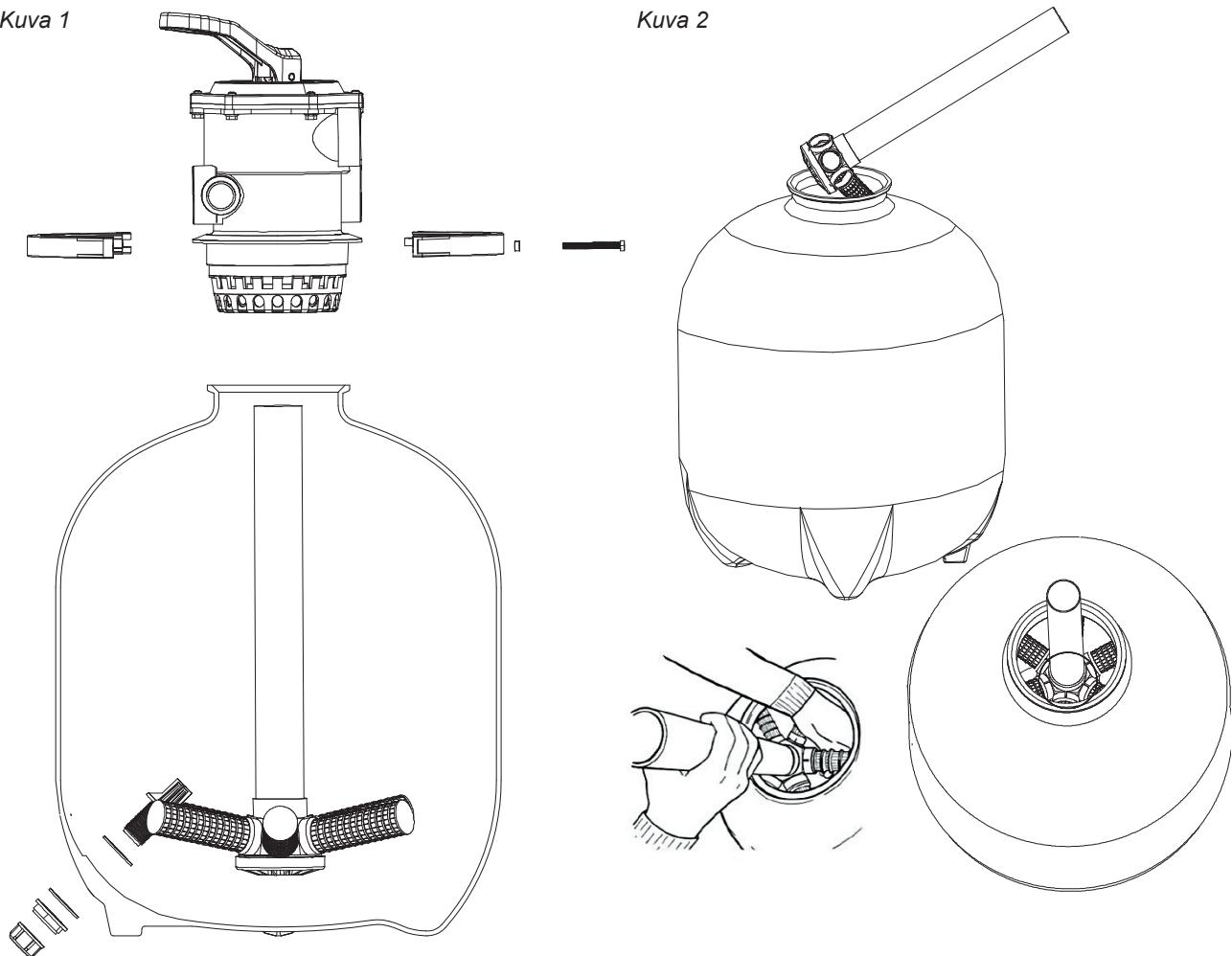
Aseta koottu jakotukki keskelle säiliön pohjaa ja täytä puolitiehen vedellä, jotta se vakautuu. Varmistaa, että tähden muotoinen verkko on hyvin keskitetty suodattimen pohjassa ja että poistoruuvi on kireällä.
