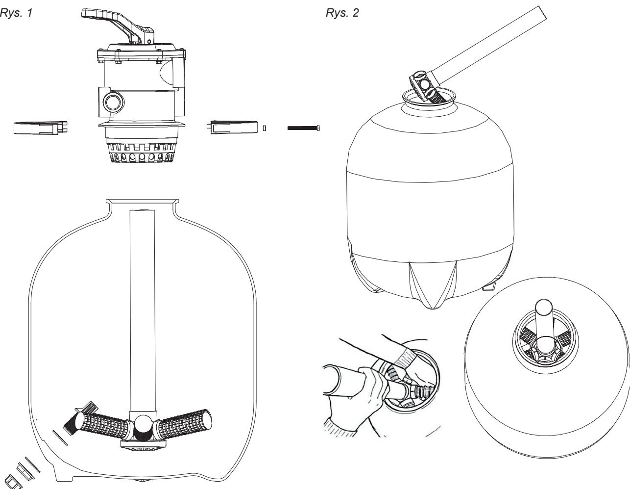
Umieścić złożony kolektor na podstawie w środku zbiornika i napełnić do połowy wodą, aby go ustabilizować. Upewnić się, że siateczka w kształcie gwiazdy jest dobrze wyśrodkowana na dnie filtra oraz że śruba odpowietrzająca jest dokręcona.
