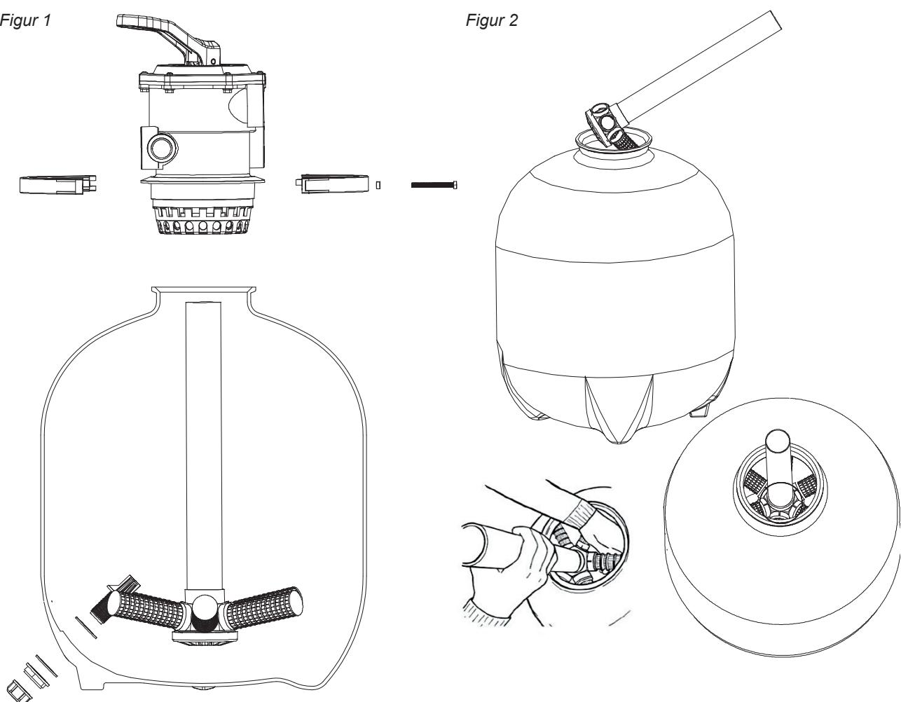
Plasser den ferdige manifoden på bunnen midt i tanken, og fyll tanken halvfull med vann for å stabilisere den. Påse at manifoden er plassert midt i filteret og at dreneringsventilen er strammet.
