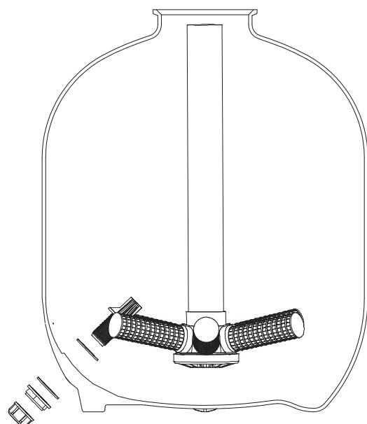
Legen Sie den fertigen Verteiler auf das Fundament in der Mitte des Behälters und füllen Sie ihn zur Hälfte mit Wasser, um ihn zu stabilisieren. Stellen Sie sicher, dass die sternförmige Gaze gut in der Unterseite des Filters zentralisiert ist und dass die Entlüftungsschraube dicht ist.
