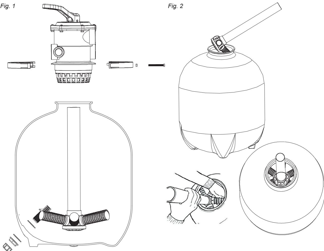
Placér den færdige manifold på bunden midt i tanken og fyld tanken halvvejs med vand for at stabilisere den. Sørg for at manifolden er placeret centralt i filteret og at drænventilen er strammet.
