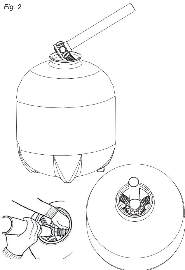
Placera det hopsatta grenröret på fundamentet i mitten av tanken och fyll det till hälften med vatten för att stabilisera den. Kontrollera att den stjärnformade väven är placerad mitt på botten av filtret och att tömningsskruven är åttagen.
